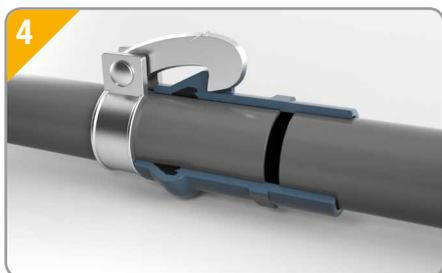
**4. Llegar con el tubo hasta el tope:** garantizaremos la estanqueidad de la unión.
